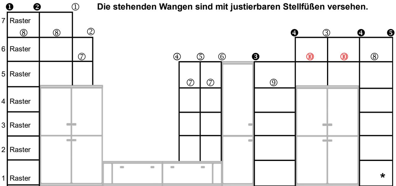
**Alle Wangen sind vorgebohrt, sodass die Böden mühelos montiert werden können.**
